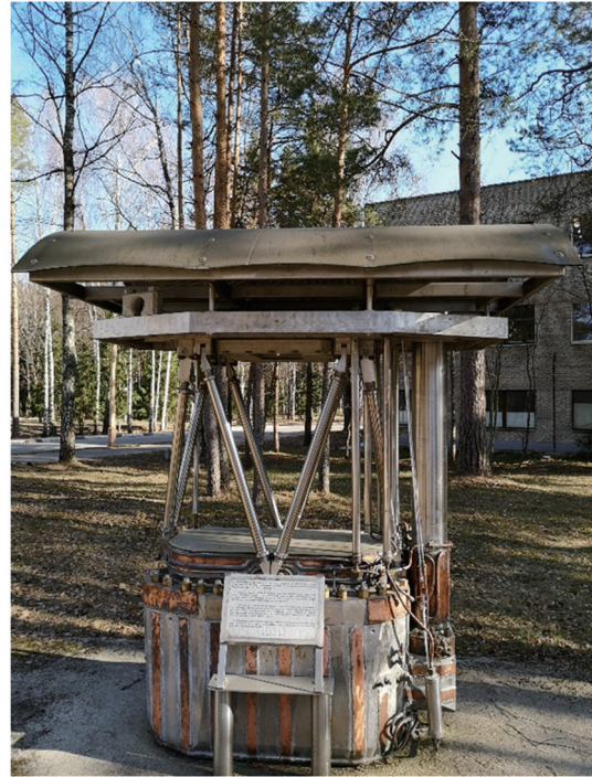
图2 王淦昌研究组建成的24 L丙烷气泡室 (刘金岩2019年4月摄于杜布纳)
