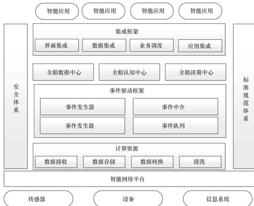
图5 基于事件驱动的船载智能信息平台架构
