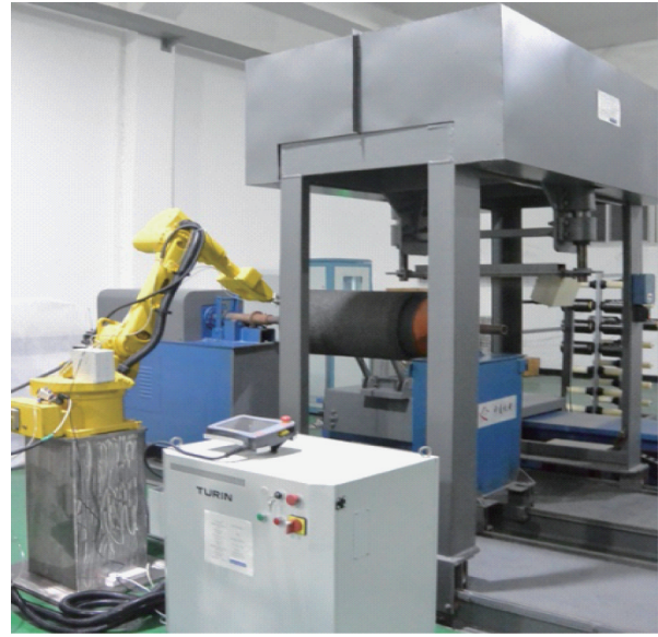
图6 六自由度数控铺放-缠绕-针刺一体机
