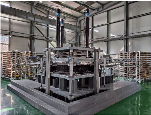
图5 数字化柔性导向多针织造成形机
