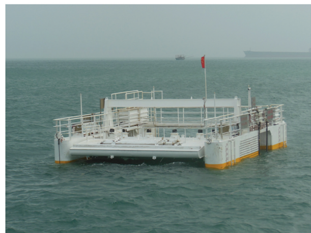
图5 “鹰式一号”10 kW 波浪能发电装置
