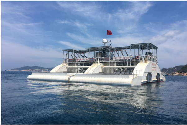
图6 海上可移动能源平台 260 kW “先导一号”
