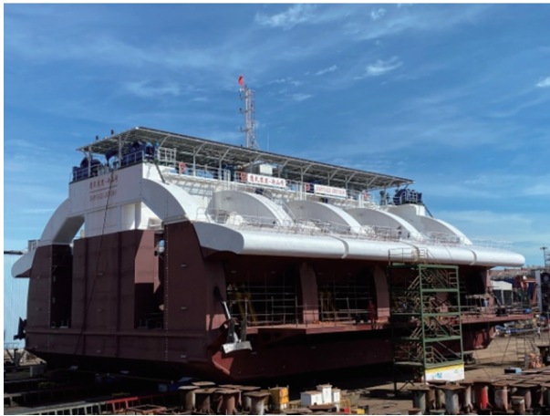
图7 鹰式波浪能 500kW 发电装置“舟山号”
