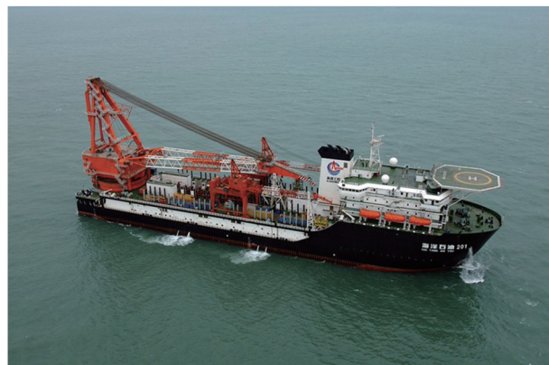
图4 中国首艘3000 m深水铺管起重船“海洋石油201”
