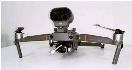
图6 增加测温标定支架的大疆御2行业双光版无人机
