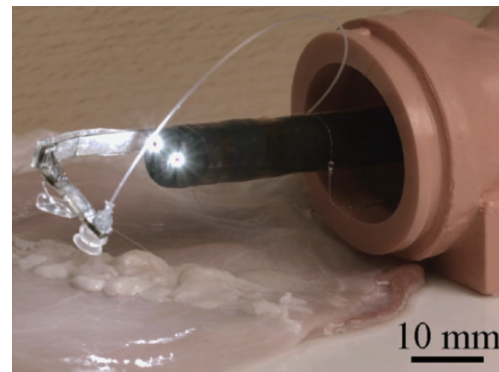
图7 软折叠臂(安装在内镜末端;猪胃离体实验)
