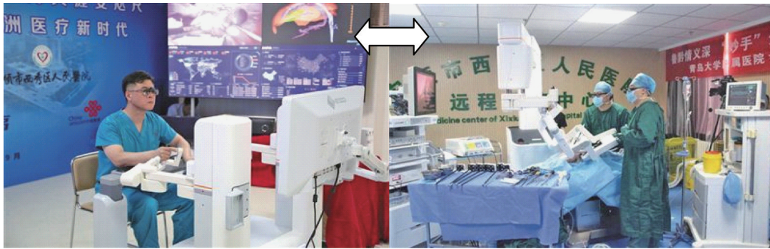
图10 5G远程机器人手术的活体动物实验
