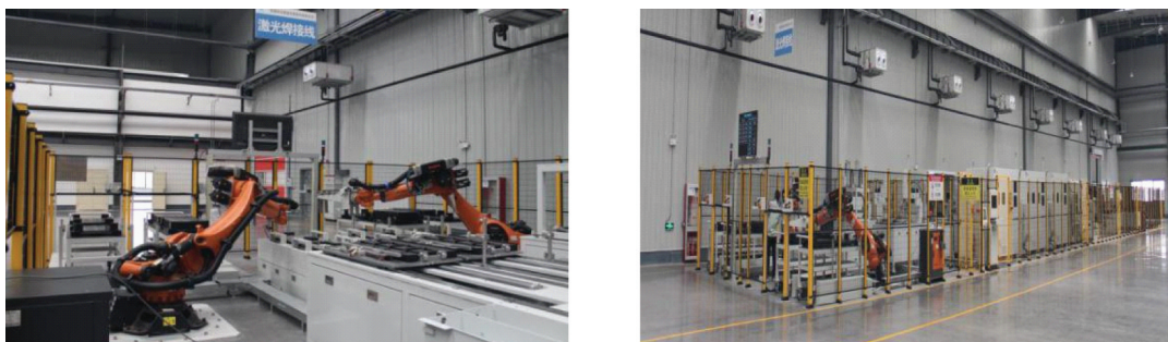
图12 安徽明天氢能能源科技股份有限公司在建电堆生产线
