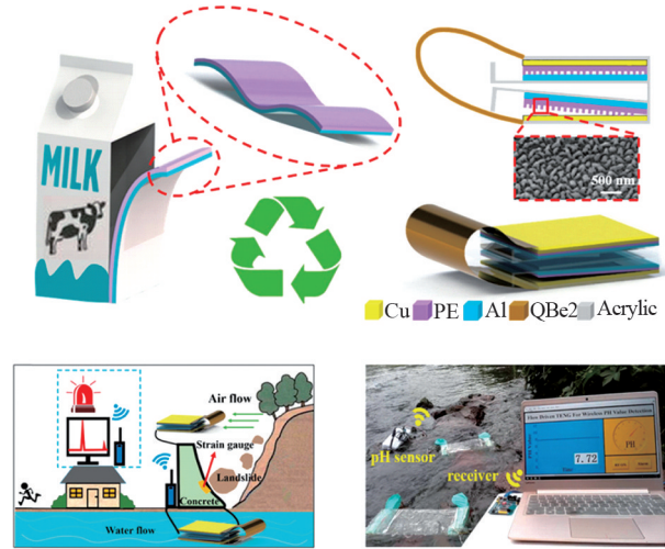
图 23 废牛奶盒制备环境友好型弧形摩擦电纳米发电机并用于河流水质监测
