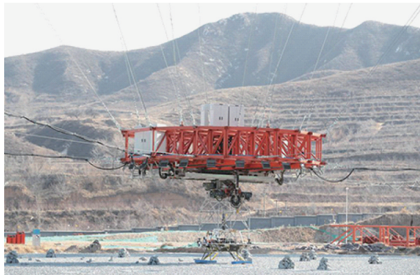
图20 中国首次火星任务着陆器悬停避障试验 (图片来源:新华网)
