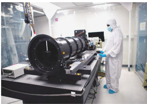
图5 NASA的新型气球载日冕仪
