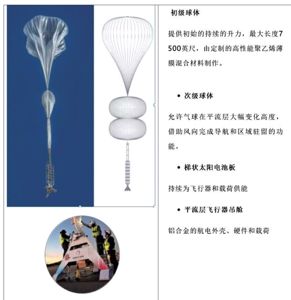
图 10 Worldview 公司的串联式超压气球
