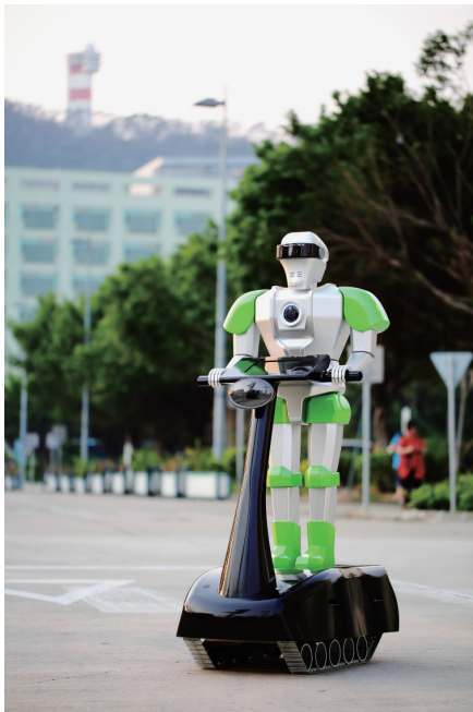
图3 “天机1号”安防服务机器人在澳门科技大学校园内执行安防考勤任务
