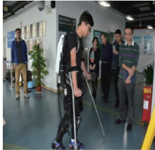
图 5 中国科学院设计的线缠绕下肢外骨骼机 Fig. 5 Wire wound lower extremity exoskeleton from Chinese Academy of Sciences
