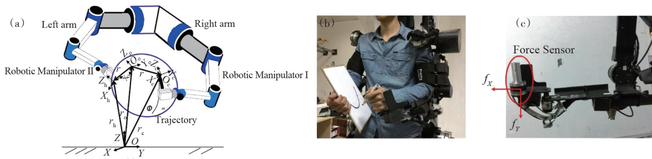
图1 基于生物力学信号控制的外骨骼机器人 [30]
