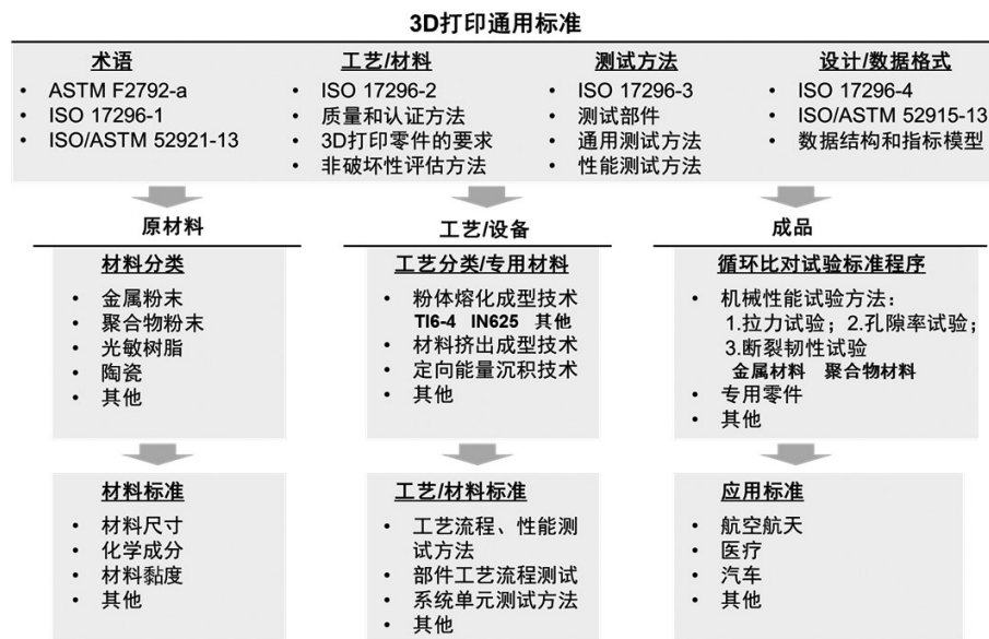
图1 3D打印国际通用标准体系框架
