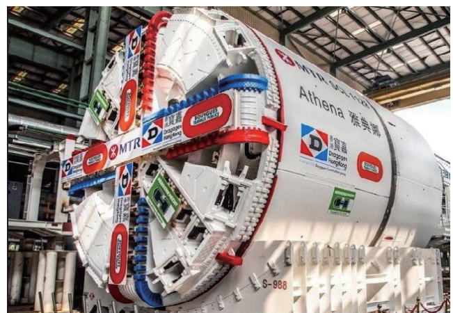
图4 用于香港沙田中环线工程的盾构机 (图片来源:中国隧道网)
