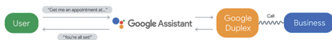
图3 用户要求 Google Assistant 进行预约,然后 Google Assistant 通过 Google Duplex 进行电话预约
