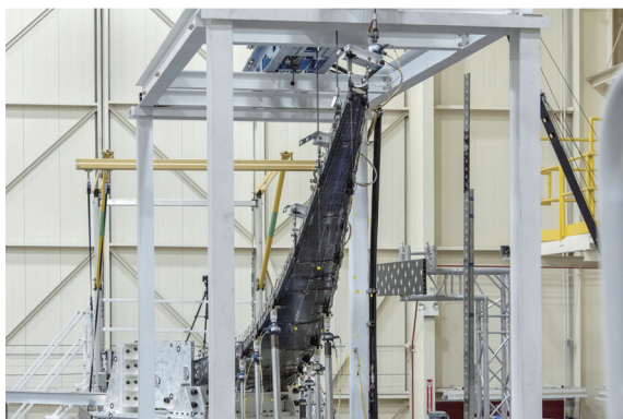
图2 机翼在最高载荷压力下的弯曲测试
