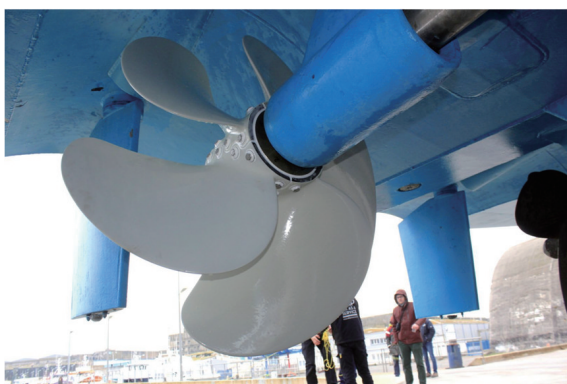
图6 Loiretech公司利用环氧碳纤维热固性复合材料生产的船用螺旋桨
