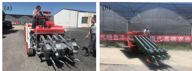
图28 4GYZ-1200自走式叶类蔬菜收获机(a)、 4GCB-2自走式甘蓝收获机(b) (图片来源:农业农村部南京农业机械化研究所)
