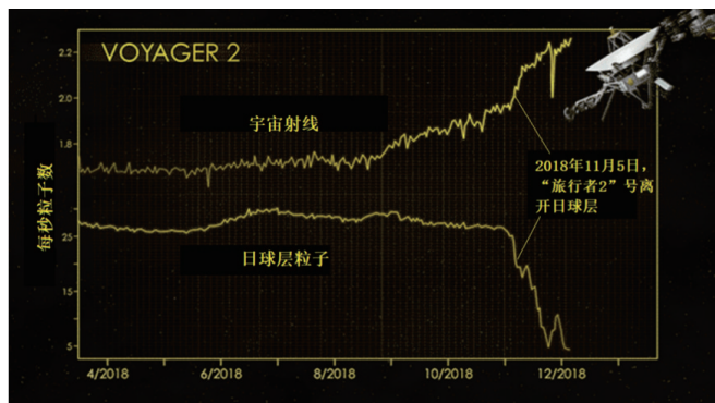
图6 “旅行者2号”的宇宙射线系统提供了离开日球层的证据(图片来源:NASA)
