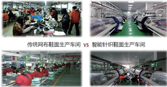
图9 传统生产工艺与自动化生产工艺的对比
