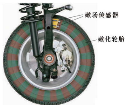
图2 磁化轮胎传感器结构
