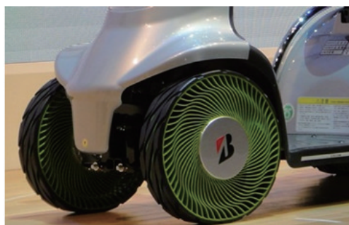
图6 普利司通的AirFree结构
