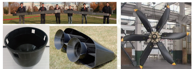
图16 中国液体成型航空复合材料在航空的典型应用
