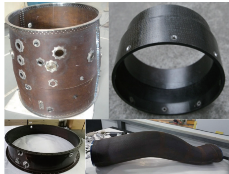
图 17 国内碳纤维聚酰亚胺复合材料在航空结构的典型应用
