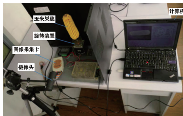
图3 玉米果穗参数图像测量装置
