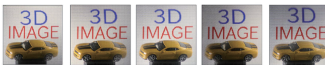
图11 基于双4f成像系统的增强现实显示效果
