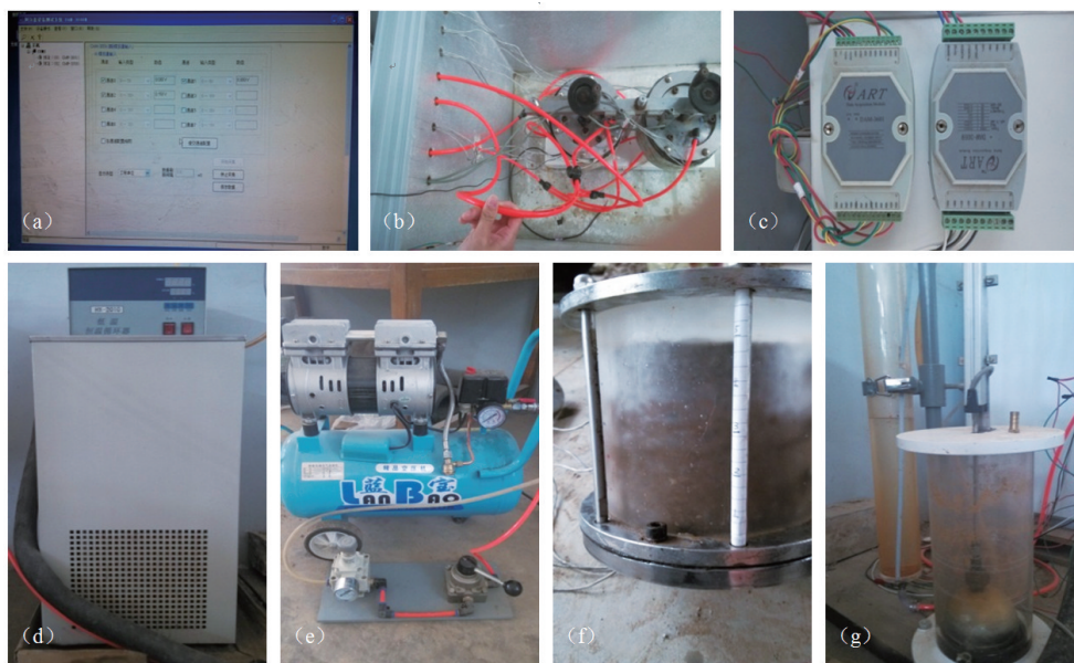
(a) 阿尔泰测控软件; (b) 恒温箱; (c) 采集器; (d) 低温恒温循环器; (e) 气动平衡加压器; (f) 试样筒; (g) 马氏补水瓶
