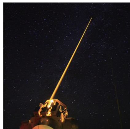
图15 TIPC钠导星激光器外场试验照片
