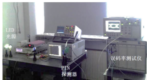
图1 带预加重功能的可见光通信系统
