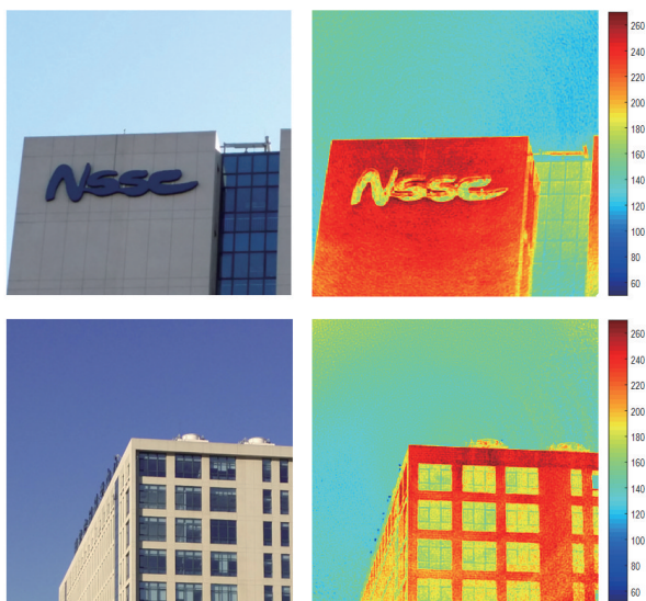
图 7 GIMS 第 2 代全尺度样机的成像结果 (左侧:光学照片 右侧:毫米波图像) Fig. 7 Imaging results of GIMS-II (Left column: optical image, right column: millimeter wave image)
