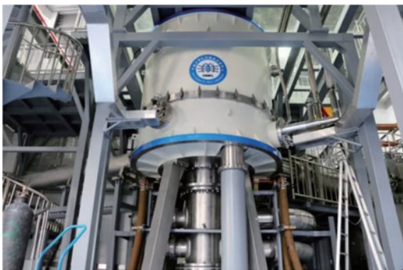
图32 混合磁体(已产生稳态磁场强度达40 T、世界第二高场强) (图片来源:中国科学院之声)
