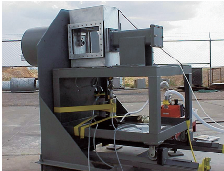
图3 第二阶段替代材料为CeO 2 的气溶胶测试装置 Fig. 3 Aerosols testing device with CeO 2 in the second phase
