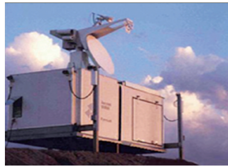
图 3 南非 Fynmeet 动态 RCS 测量系统 Fig. 3 Measurement system of dynamic RCS in South Africa
