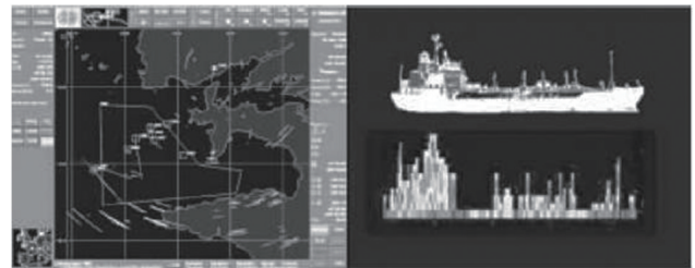
图6 Ocean Master雷达监视和ISAR成像画面
