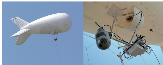
图7 快速浮空器初始部署系统(RAID)及其携带的侦察设备
