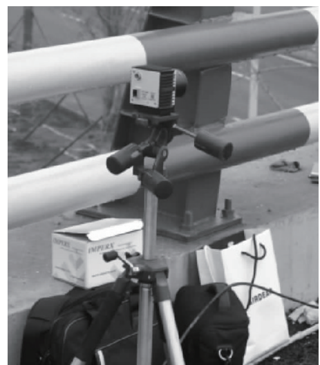
图8 桥上设置摄像系统
