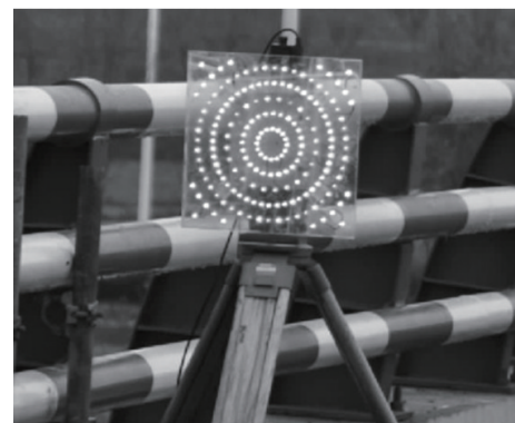
图7 桥上设置靶面系统
