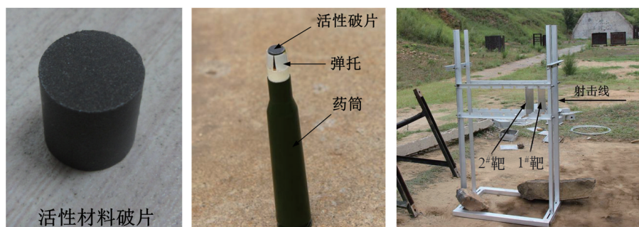
图2 活性破片、实验弹和双层间隔靶照片
