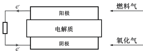
图1 燃料电池工作原理示意 Fig. 1 Schematic of fuel cell
