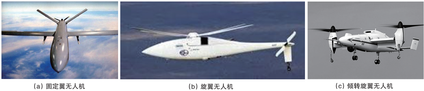
图1 按照机翼工作原理分类的无人机
