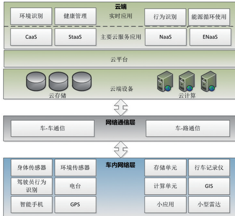
图8 VCC网络架构
