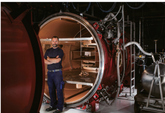
图9 AWTSII风洞系统,可见内部测试段和外部的冷却系统 [61]
