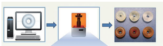
图 13 SLA 3D 打印药物流程
