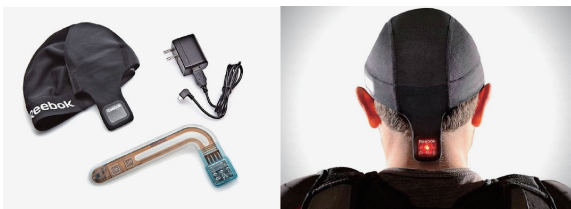
图9 橄榄球员用的头部撞击测量传感器
