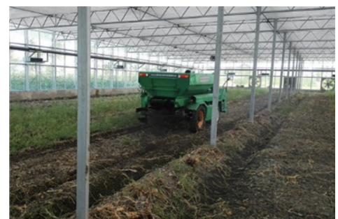
图 26 园艺固肥施用、残秧处理多功能机作业情况
