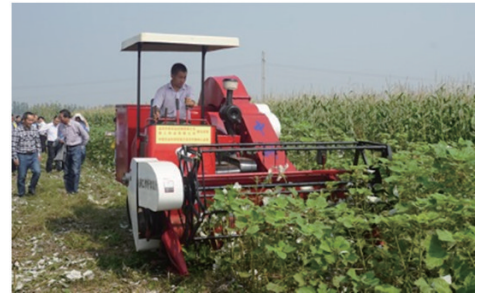
图29 4LZ-130型饲用苕麻收割机田间作业
