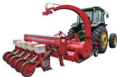
图 25 旱田全量秸秆覆盖地免耕区播种机及其田间作业
