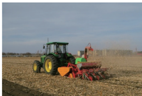
图 25 旱田全量秸秆覆盖地免耕区播种机及其田间作业
