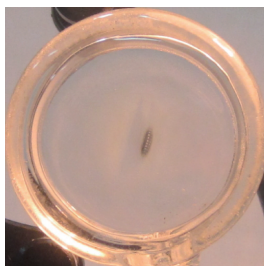
图7 碳粒污染的蒸气室
