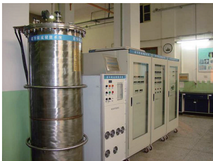
图 8 中国科学院电工研究所研制的 SFCL-MES Fig. 8 Scene of SFCL-MES of Institute of Electrical Engineering Chinese Academy of Sciences
