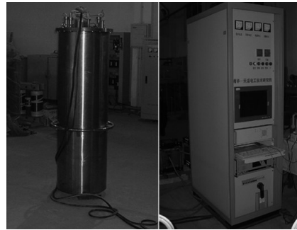
图 10 清华大学 0.3 MJ/150 KV·A SMES Fig. 10 0.3 MJ/150 kV·A SMES by Tsinghua University
