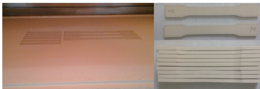
图4 激光加工竹粉/聚酯复合粉末及所烧结的拉伸测试件
