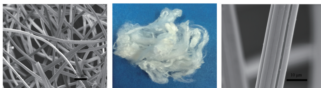
(a) 竹纤维的低倍扫描电镜图
