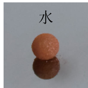
图7 磁性超疏水纤维素粒子包裹水滴形成的液体弹珠
