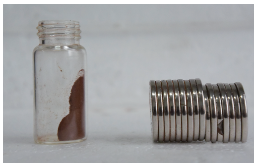
图5 超疏水磁性纤维素粒子在磁力驱动下移动
