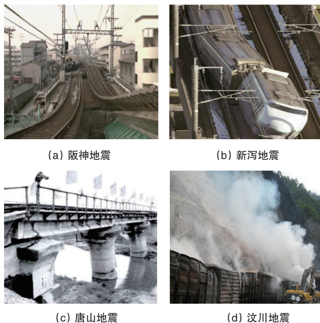
图 1 地震导致的铁路列车脱轨事件
