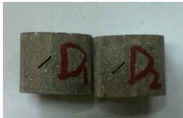
图1 类岩石试样(裂隙倾角45°)
