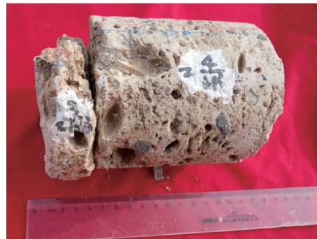
(b) S1井,780.79-780.90 m,含陆屑砾屑粉晶灰岩,相缘混合,溶洞发育
